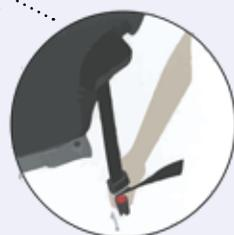
Correas de sujeción al suelo auto-ajustables para evitar el efecto rebote en un posible accidente
