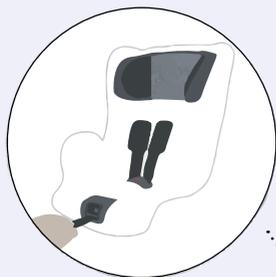
Puedes ajustar la altura del reposacabezas tirando del arnés
